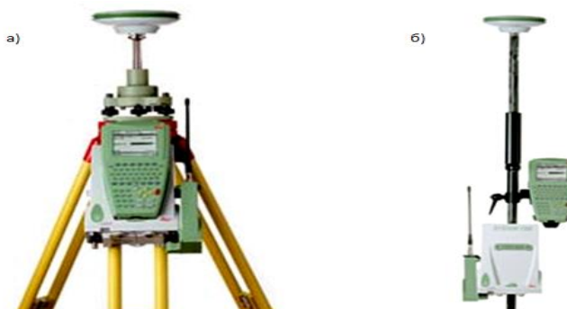
22 сурет. а) Штативке орнатылған GPS1200 сериялы қабылдағыш; б) вешка орналасқан антенна, далалық ровер және модем
